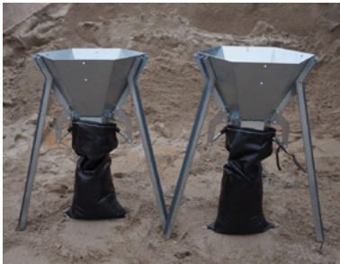
Abb.34: Fülltrichter (SAQUICK) (THW)
