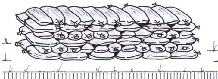
Abb. 51: Stapel versetzter Sandsäcke (Bauhandbuch der Armee)
